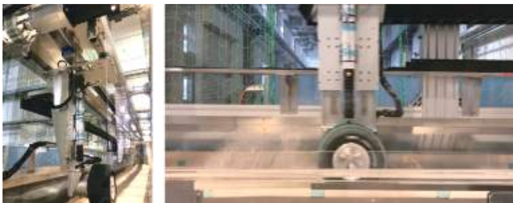
図 開発した単輪走行試験装置 (左図：直径 260mm の車輪を用いて、最大 6m の走行実験を行うことができる。 右図：珪砂土壌を走行する実験の様子。最大速度 20km/h の実験が可能。)
