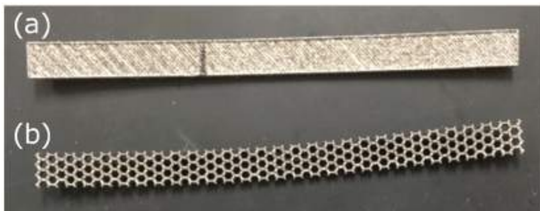
図 11 Fe 52 -Co 48 合金の外観：(a) は緻密構造、(b) はハニカム構造である。なお、(a) の黒線は、固定する場所を決めた際の目印である。
