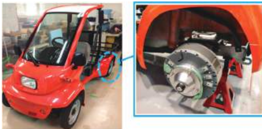
図1 アキシシャルギャップ SR モータを搭載した小型 EV (左) とモータ部の拡大写真 (右)
