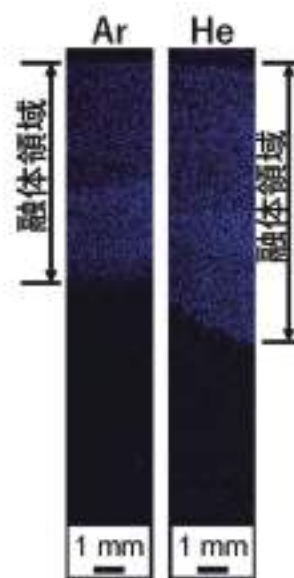
図10 Wトレーサーを用い(左)Arプラズマアークおよび(右)Heプラズマアーク溶解後のTi-6Al-4V合金試料の融体領域
